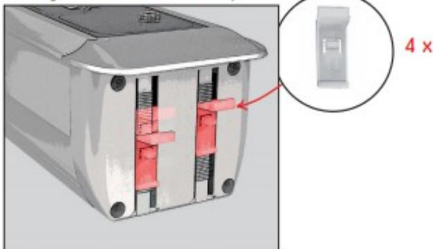
**Zusätzliche Befestigung bei Tragarm-Montage**
