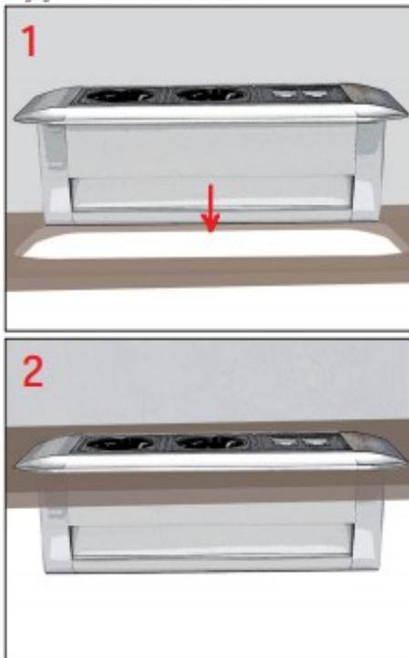
**Befestigen der NETBOX Line durch Rastmechanismus**
